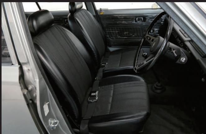
前排座椅採用分離式設計，可前後滑動並調整靠背角度。
