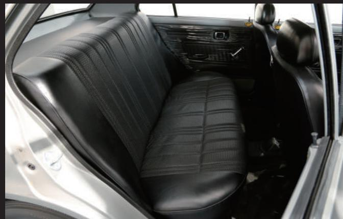
後排座椅比前排座椅高25mm，以確保視野。座椅高度不可調整，但腿部空間寬敞，可舒適乘坐。
