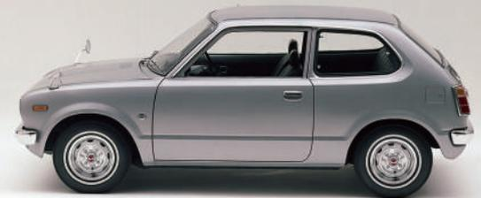
為了方便後座乘客上下車，採用了大型車門。車窗採用沒有三角窗的大型曲面玻璃。
