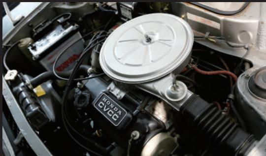
搭載CVCC引擎車輛的引擎室。昭和48年車型的引擎最大輸出功率為63ps，動力性能略低於傳統型號，但其超越傳統的低污染性能受到高度評價。
